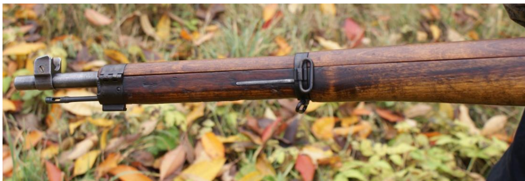
Masywna osłona muszki i podwójne mocowanie pasa karabinu M 39
