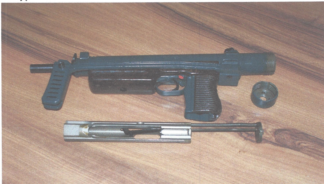
Broń częściowo rozłożona, teraz można wykręcić lufę
